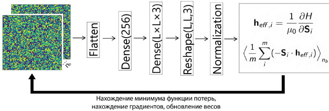
Рис. 1. Схема алгоритма, состоящая из двух полносвязных нейронных слоев (Dense), где слой преобразования в вектор (Flatten), слой преобразования размерности (Reshape), слой нормализации (Normalization)
